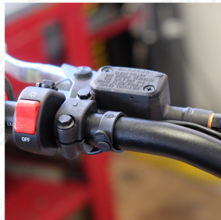
Rimontare interruttore luci/ Fit light switch
